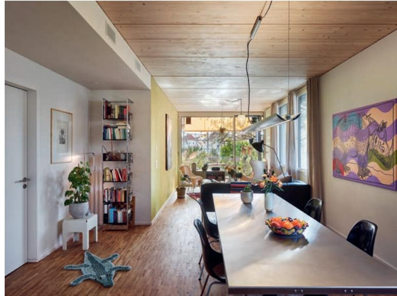
Die angestrebte Einfachheit zeigt sich auch in der Materialisierung: Die Wände bestehen aus Brettschichtplatten und Holzelementen, die Decken aus unten sichtbaren Massivholzelementen.
